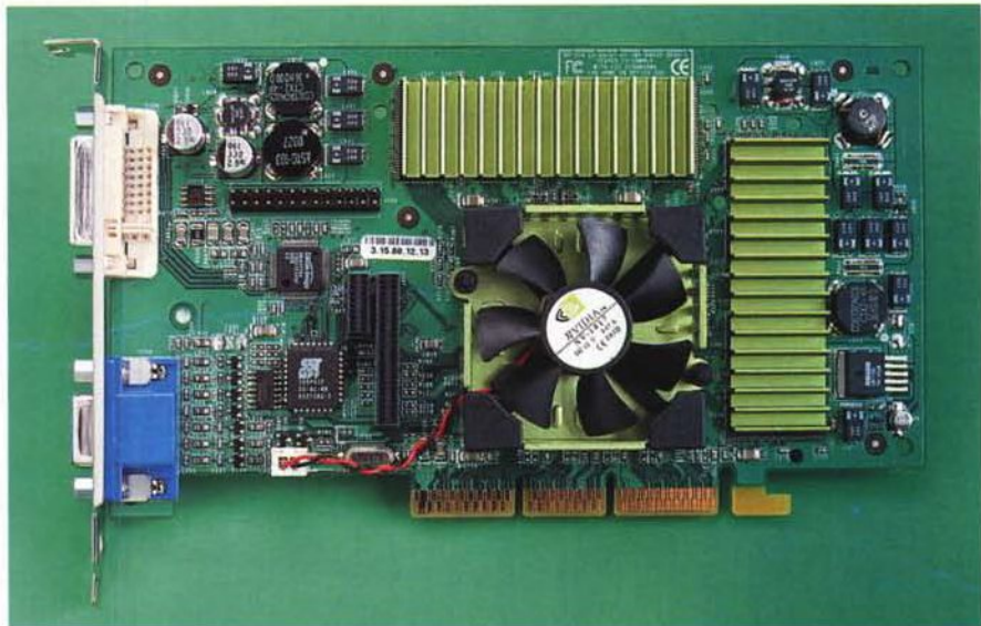
La scheda video cuore della workstation: la Elsa Gloria III, con 64 MByte di RAM DDR e GPU nVidia Quadro 2 Pro; si nota subito il dissipatore corredato di ventolina del processore grafico e i dissipatori ai lati di questo, destinati a raffreddare i chip di memoria. La scheda è anche dotata di uscita digitale per il pilotaggio di un display LCD-TFT.
